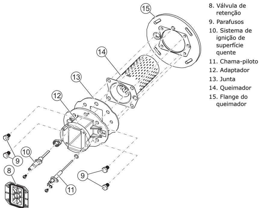
Usar ar comprimido para remover todas as contaminações do queimador, de fora para dentro.
