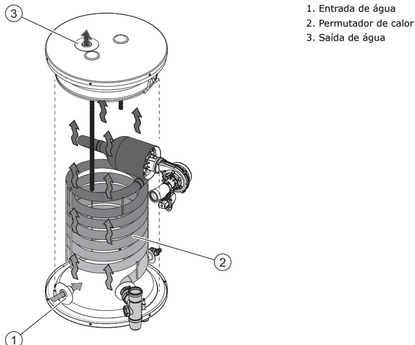
Quando a temperatura é demasiado baixa, o aquecedor de água inicia um ciclo de operação:
