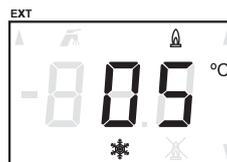
Para evitar que a água no sistema congele, a proteção contra congelação é ativada quando o aquecedor de água está no **modo OFF**. A proteção contra congelação é iniciada quando a temperatura da água desce abaixo dos 5 °C. O visor mostra o símbolo de proteção contra congelação. O aquecedor de água irá aquecer a água para 20 °C e depois retorna ao **modo OFF**.
