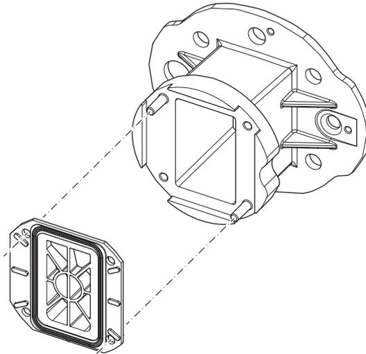
6. Instalar o burner engine com dois parafusos no adaptador.
