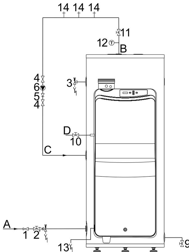
1. Válvula de redução de pressão (obrigatória, se a pressão da água da rede de distribuição for demasiado alta)
