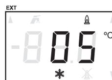
Per impedire che l'acqua contenuta nell'impianto congeli, la protezione antigelo si attiva anche quando lo scaldacqua si trova in **modalità OFF**. La protezione antigelo si avvia quando la temperatura dell'acqua scende sotto 5°C. Sul display viene visualizzato il simbolo della protezione antigelo. Lo scaldacqua riscalda l'acqua fino a 20°C per poi tornare in **modalità OFF**.
