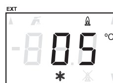
Fig. Protección contra heladas activada
