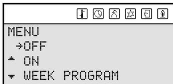
5. Pulse una vez la flecha azul (↵) para poner el indicador delante de **ON** y pulse en **ENTER**. Aparecerá la pantalla tal como se indica en la figura.
