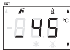
Fig. Actual water temperature
