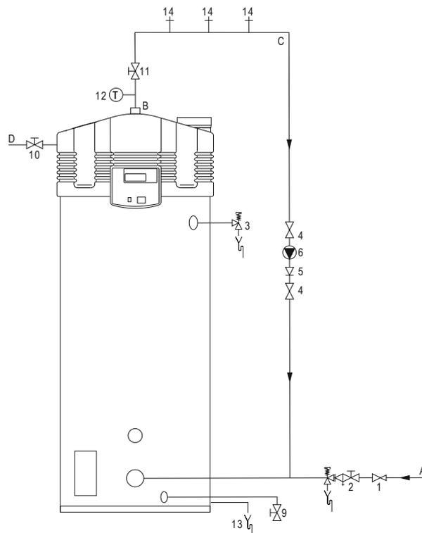
1. Druckminderer (vorgeschrieben, falls der Wasserleitungsdruck zu hoch ist)
